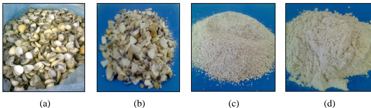
Figura 5. Conchas de amêijoa: (a) sem trituração (b) triturada em grandes partes, (c) classificadas a 20 mesh e (d) classificadas a 100 mesh.
