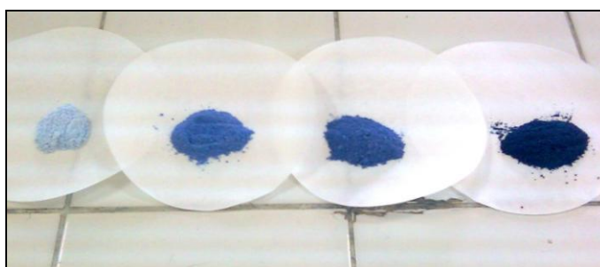
Figura 21. Comparação da coloração do adsorvente após adsorção em concentrações crescentes do corante Nylosan.
