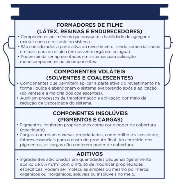
Figura 01 - Categorias de materiais que compõem formulações de tintas e suas características principais em função do papel que desempenham no sistema de formador de revestimento.
