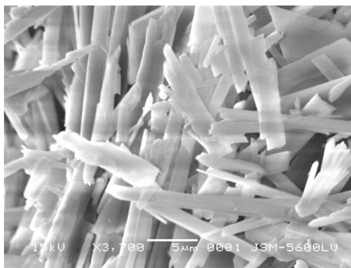
Figura 4.2 – Micrografia dos cristais de gesso formulados em condições favoráveis ao controle de parâmetros operacionais ( T=170^{\circ}\text{C} e P=0,65\text{ atm} )
