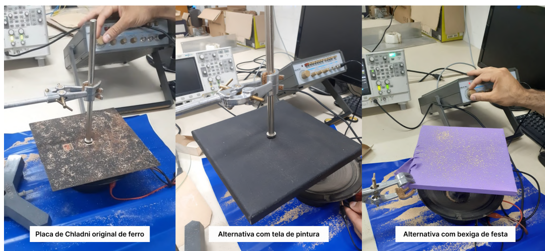
Figura 29 – Placa de Chladni e alternativas desenvolvidas, respectivamente.
