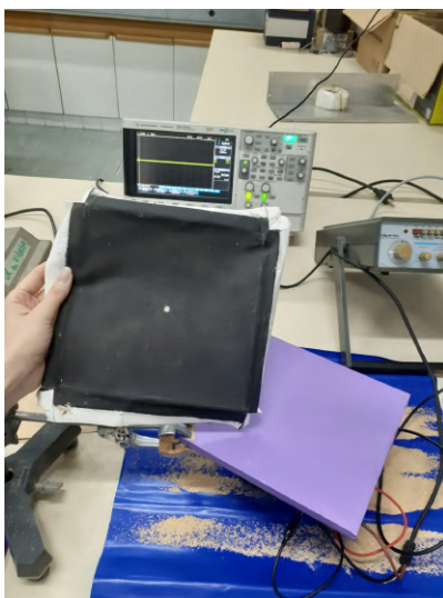
Figura 32 – Tela de pintura desmontada ao lado da placa montada com a estrutura da tela e a bexiga
