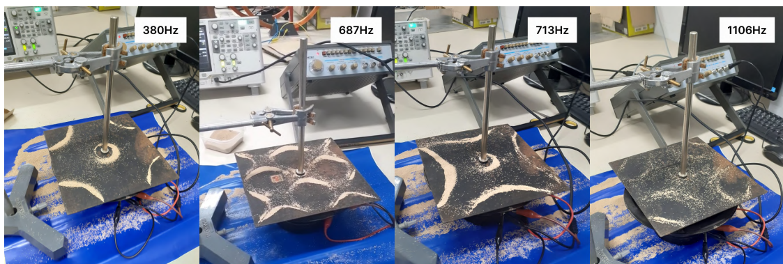
Figura 30 – Padrões e frequências detectadas utilizando a placa de Chladni de metal
