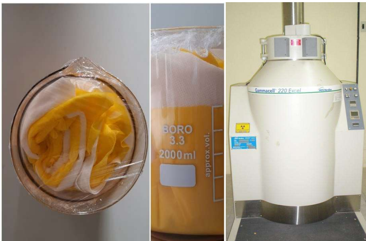
Figura 8 – Amostras preparadas para a irradiação gama (à esquerda), Becker contendo as amostras (centro) e irradiador Gammacell 220 Excel (à direita)
