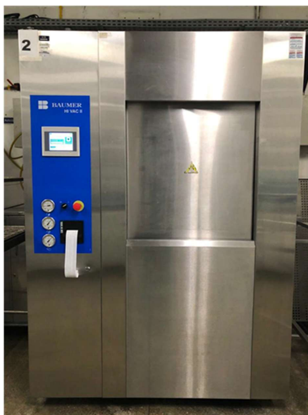
Figura 3 – Equipamento de esterilização/descontaminação com vapor de peróxido de hidrogênio
