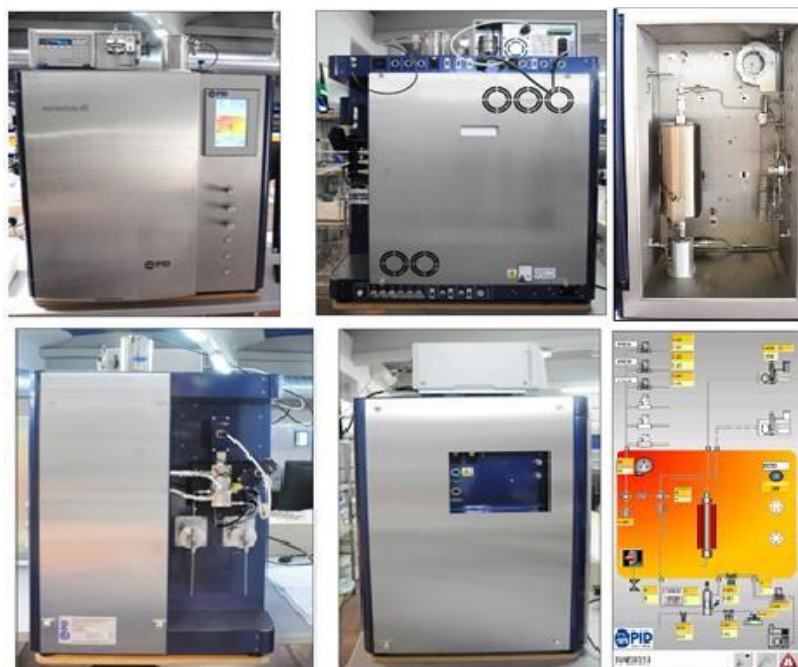
Figura 15- Vistas laterais, frontal e interna da unidade MICROACTIVITY-effi da Eng&Tech
