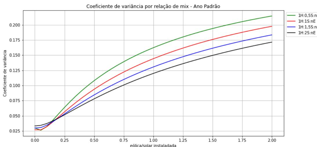
Figura 46 – Estabilidade absoluta vs relação eólica / solar instalada ano padrão- Sobradinho
