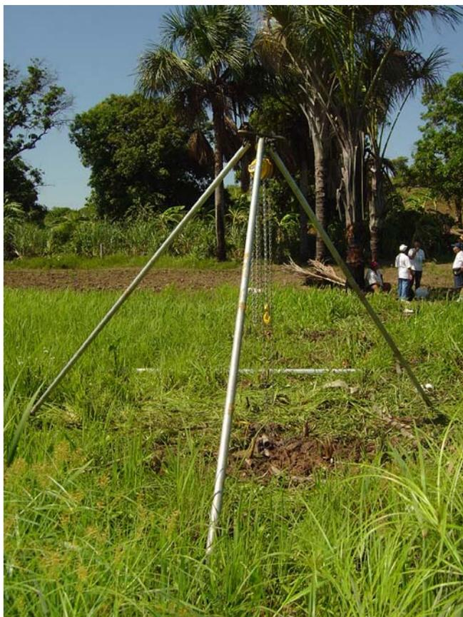
Figura 12 - Sistema de tripé e roldanas montado para a coleta do testemunho palinológico, na planície flúvio-lacustre da Lagoa Grande.
