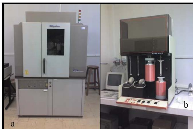
**Figura 08** - Difratorômetro de Raios-X Rigaku Ultima (a); Analisador de área superficial específica (BET) Micromeritics ASAP 2010 (b).
