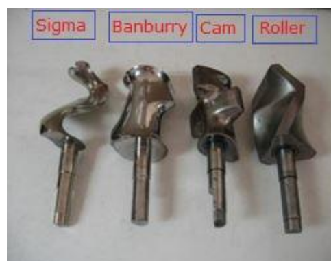
Figura 14 - Tipos de rotores, a performance aumenta da esquerda para a direita.
