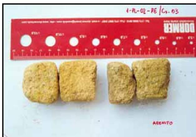
Foto 5.31 – Arenito calcífero creme amarelado de granulometria média, fossilífero, e com dolomita recristalizada da sublitofácies **Arc<sub>2</sub>**, a preponderante na unidade, e passando para um arenito duro, compacto, de grã fina. Furo 1-PL-01-PE, na Sub-bacia Olinda.
