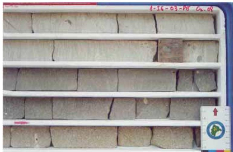
Foto 5.21 – Passagem do arenito carbonático fino com nódulos de fosforito (nas três calhas inferiores), para um calcário cinzento bioturbado (nas duas calhas superiores). Testemunho do furo 1-IG-03-PE mostrando o contato entre a Formação Itamaracá e a Formação Gramame, quando falta a camada fosforítica.
