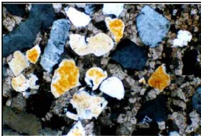
Foto 5.34 – Fotomicrografia do arenito calcífero Itamaracá, constituído essencialmente por quartzo, em cristais com bordas relativamente sem corrosão e contatos intergrãos pontuais ou frouxos denunciando diagênese média a fraca. Entre os grãos quartzosos há presença de calcita espática como cimento. Furo 1-IG-03-PE, em Igarassu. Aumento 4x e NX.
