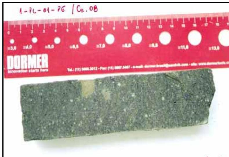
Foto 5.12 – Testemunho de Sondagem do Furo 1-PL-01-PE, representando a seção condensada entre o TST e o TSMA (arenitos calcíferos e carbonatos), constituída de arenito calcífero com muitos grãos de fosforito, os quais são envolvidos por matriz margosa em direção ao carbonato bioturbado, evidenciando processo erosivo sobre o estrato com baixa deposição.
