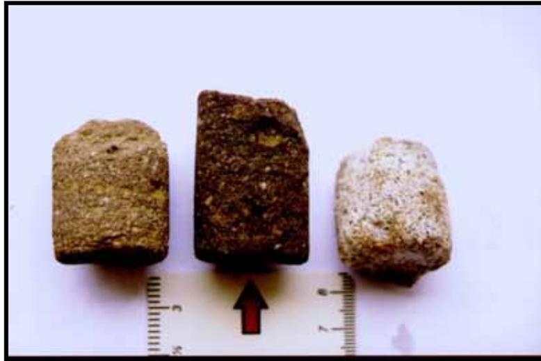
Foto 5.11 – Furo de Sondagem SR-C-07, em Goiana-PE, mostrando a superfície de discordância (arenito grosso, escuro), entre a fácies **Agm**, de rios entrelaçados, da unidade inferior (coloração amarelada) e a fácies **Arc**, de praia/planície litorânea (coloração esbranquiçada), do Sistema Costeiro.
