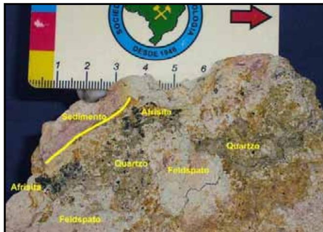
Foto 5.26 – Rocha cristalina alterada inclusa na base da Litofácies **Cgd**, mostrando o feldspato já alterado para argila, mas ainda distinguindo-se o quartzo e a afrisita. Localidade de Passarinho.
