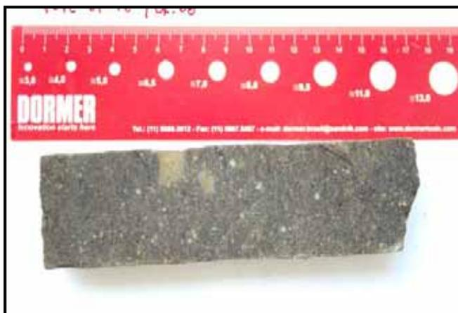
Foto 5.30 – Arenito que representa a sub-litofácies **Arc<sub>1</sub>**, apresentando granulometria média a grossa, coloração escura e diagênese média a forte, com grãos quartzosos e moldes quebrados de fósseis destacados na matriz. Testemunho do furo 1-PL-01-PE.
