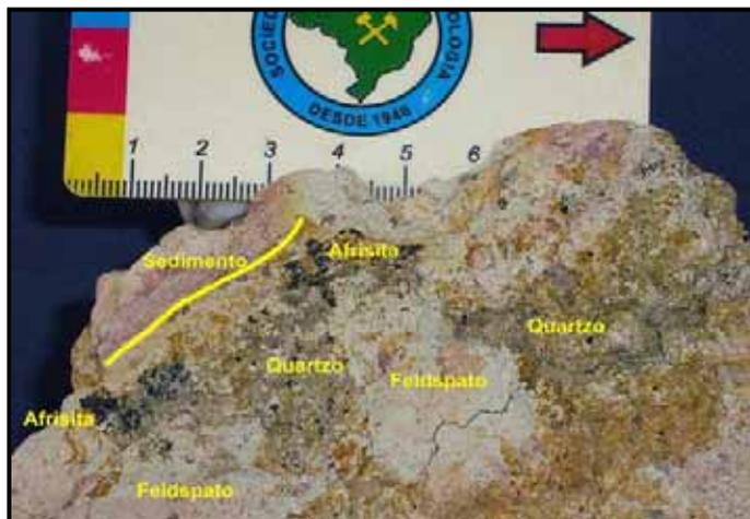
Foto 5.16 – Bloco de rocha cristalina alterada, mas permitindo reconhecer a mineralogia (quartzo, afrisita e feldspato alterado para argila), encontrado na porção basal do afloramento na localidade de Passarinho, e correspondendo ao nível A da Foto 5.15.
