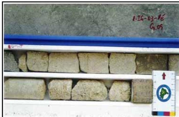
Foto 5.10 – Furo de Sondagem 1-IG-03-PE mostrando a mesma transição escura (discordância), na segunda calha, de baixo para cima, logo acima da régua.
