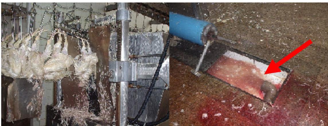
Figura 4.12 – Aves sendo depenadas e reúso da água para não acumular as penas.
