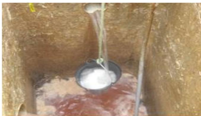
Figura 3.4 - Procedimento de medição de vazão adotado, para estimar a vazão dos efluentes gerados no abatedouro Serrote Redondo.
