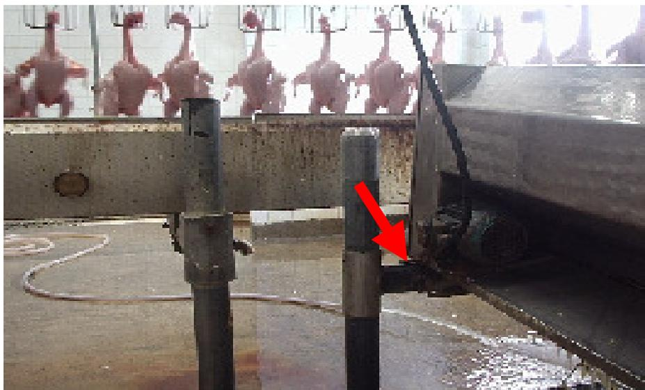
Figura 4.11 – Mangueira com vazão de 40 litros por minuto.
