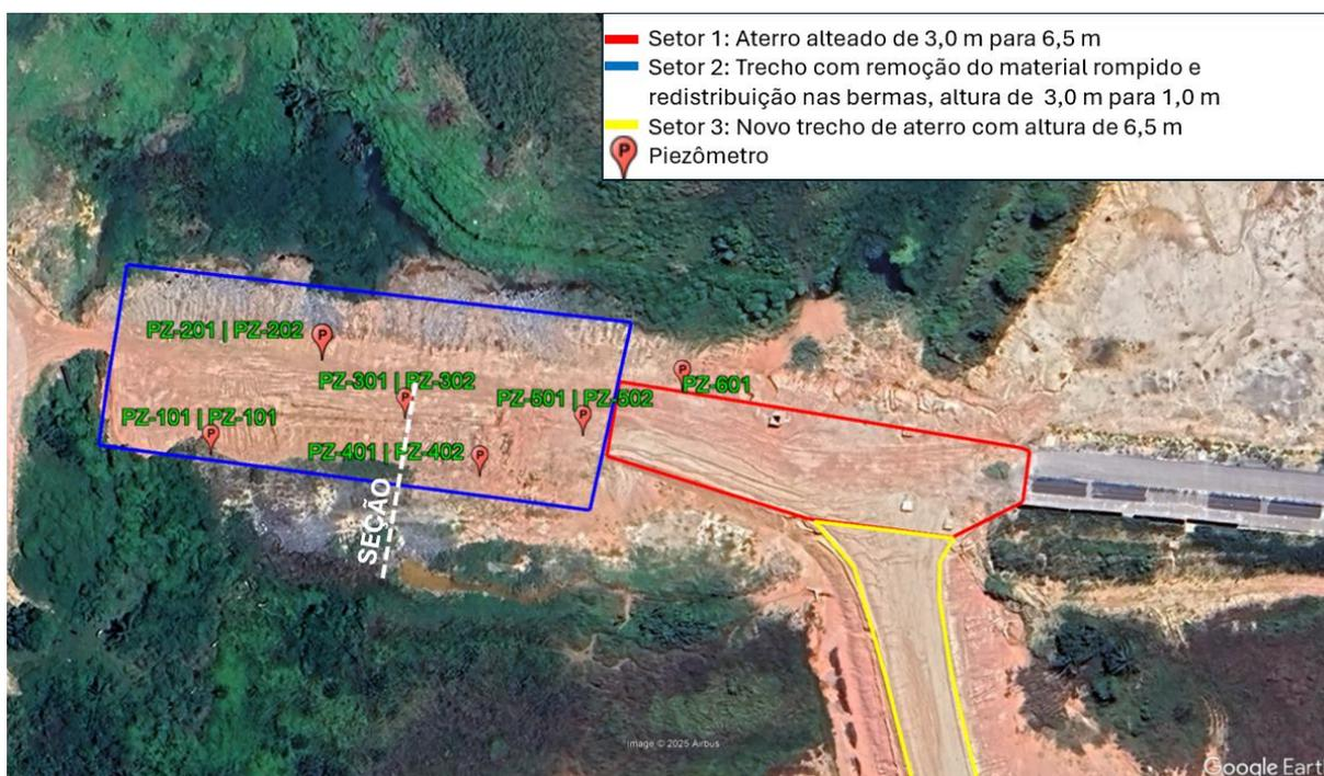
**Figura 37:** Planta com a disposição dos instrumentos.
