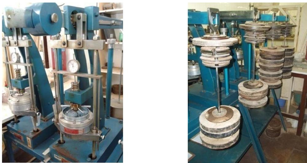
**Figura 39:** Prensa utilizada no ensaio de compressão edométrica convencional.
