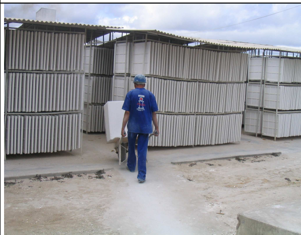
FOTO 6: Fábrica de pré-moldados: transporte e secagem.
