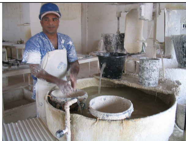
FOTO 12: Uso da água na fabricação de pré-moldados.
