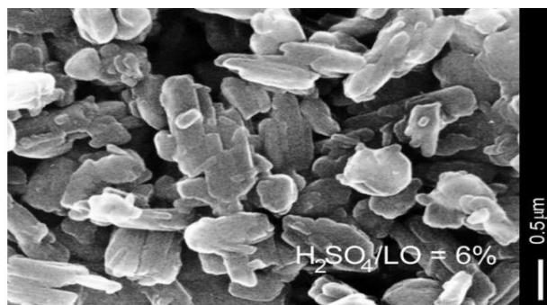
FIGURA 2.16. Morfologia de uma massa 3BS preparada com razão H_2SO_4/LO de 6% e temperatura inferior a 80^\circ C . Fonte: (PAVLOV, 2011).
