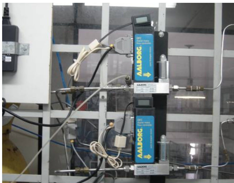
Figura 14: Controladores de fluxo mássico da Alborg, usados nas reações.
