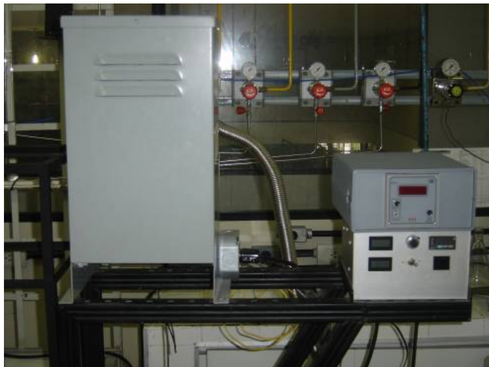
Figura 13: Acessórios do reator membrana, composto por forno de aquecimento, leitor do termopar, controlador de temperatura e leitor dos gases refinados e permeados.
