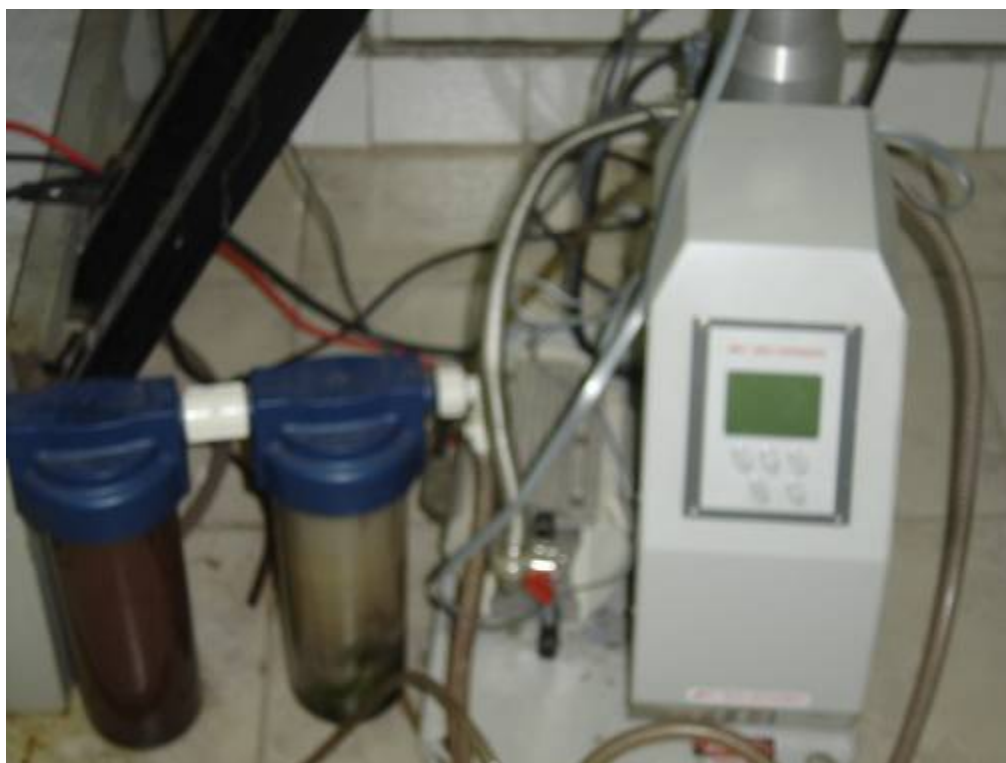
Figura 12: Bomba de vácuo do reator membrana, acoplada com filtro de água.
