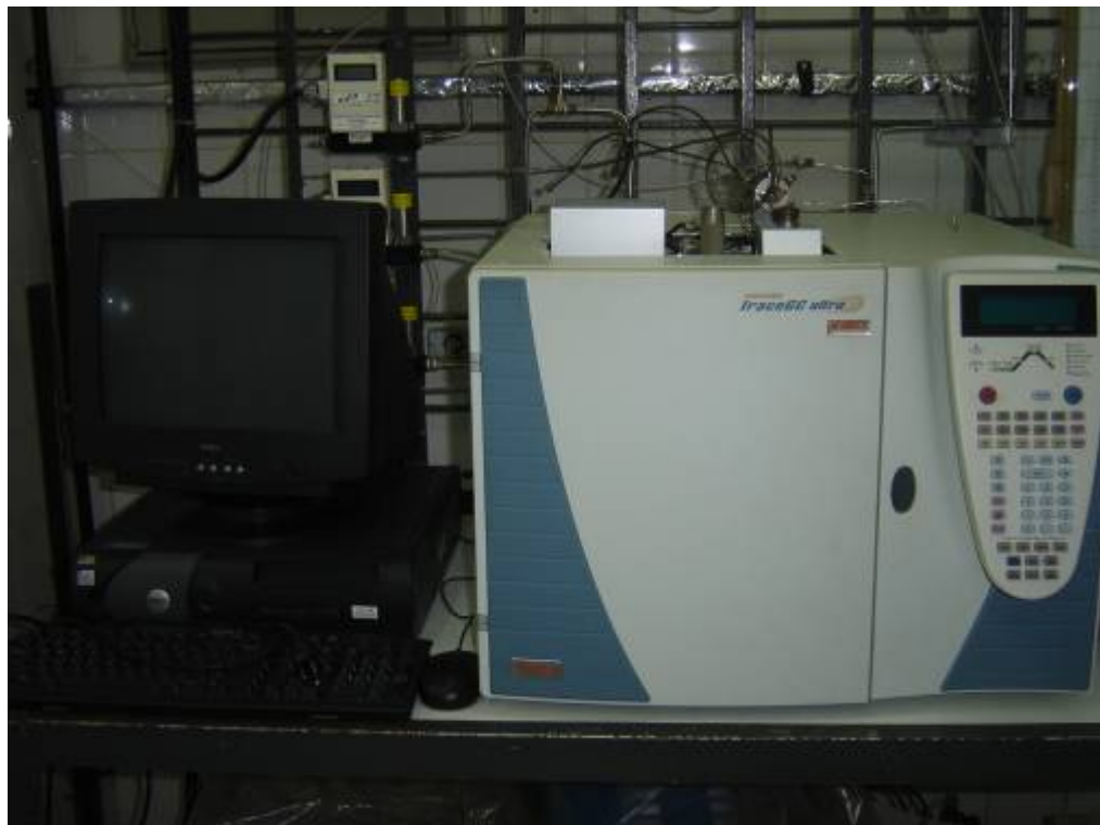
Figura 9: Conjunto do sistema de análise dos afluentes e efluentes dos reatores de processamento. Destaque do Cromatógrafo a gás Thermo-Finishing.
