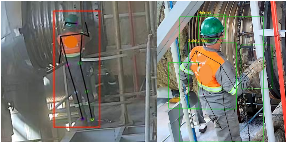
Figura 33: Testes de detecção de pose, destacado pelos círculos das juntas conectados por linhas pretas.
