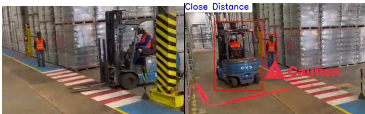
Figura 35: Teste de interação de veículo-pessoa. Em cima da imagem de alerta tem a descrição do desvio.
