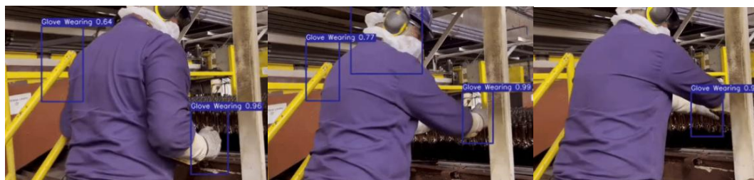
Figura 21: Sequência de frames próximos com identificações erradas.
