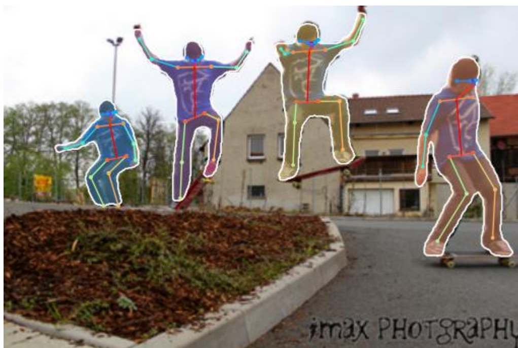
Figura 14: Representação da saída do Keypoint R-CNN.
