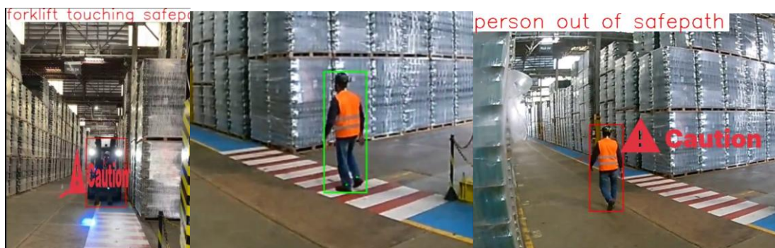
Figura 36: Testes de veículo-sinalização/homem-sinalização; à esquerda, um veículo passando por cima da faixa, no meio uma pessoa andando corretamente e em seguida fora da faixa de pedestres. Em cima das imagens de alerta tem a descrição do desvio.
