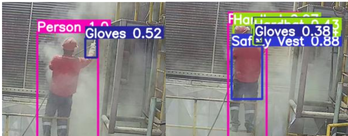
Figura 31: Teste de detecção de EPIs em ambiente poluído.
