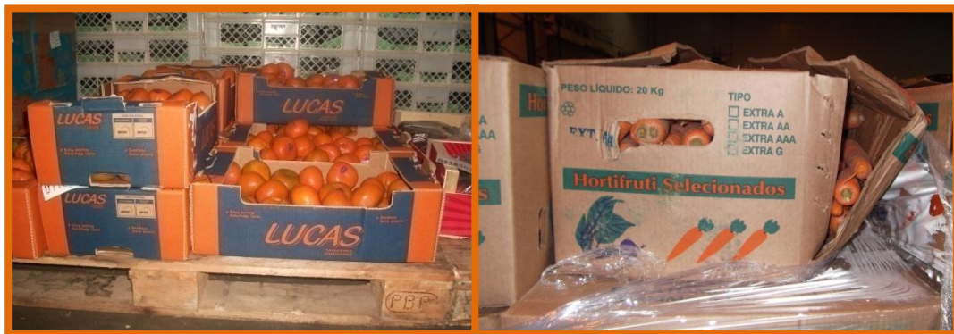
Figura 12 – Embalagem de papelão ondulado que proporciona empilhamento e outra com sua estrutura danificada e não paletizável, encontrada da Central de Distribuição. Fonte: pesquisa direta, 2011.
