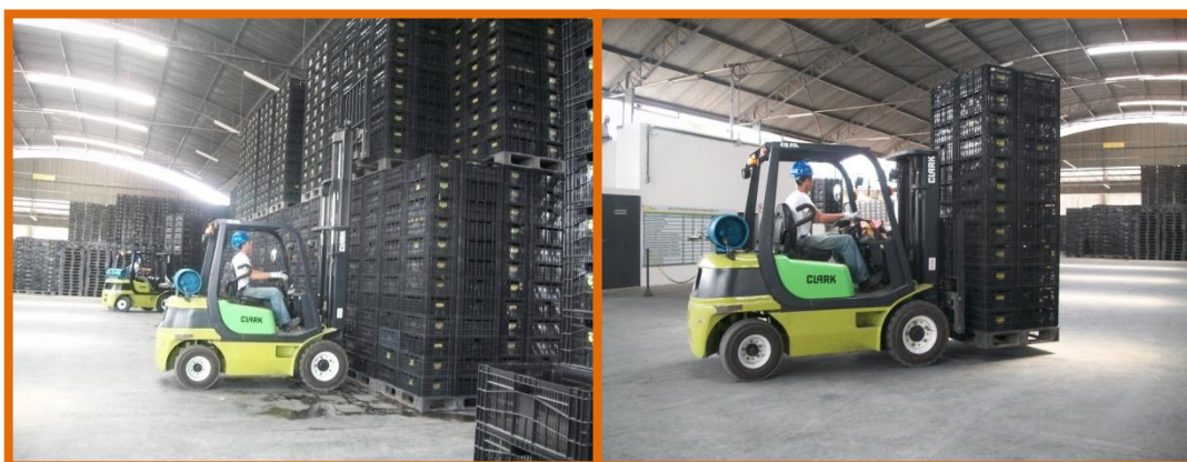
Figura 14 – Embalagens de plástico empilhadas no pallet sendo movimentadas por uma empilhadeira na Central de Embalagens da CEASA-PE. Fonte: pesquisa direta, 2011.
