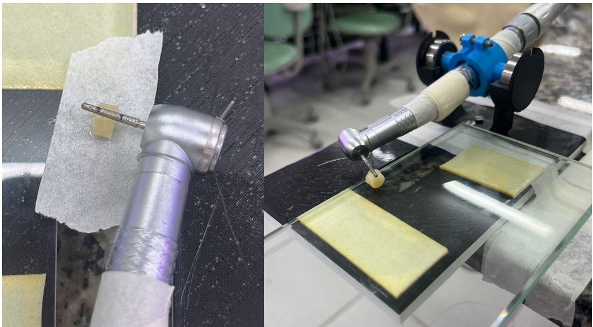
Figura 7. Peça de mão na estrutura impressa com filamento PLA, com rotação e marcação padronizados. Nela, foi adicionado fio de nylon para suportar o peso fixo de 150g.
