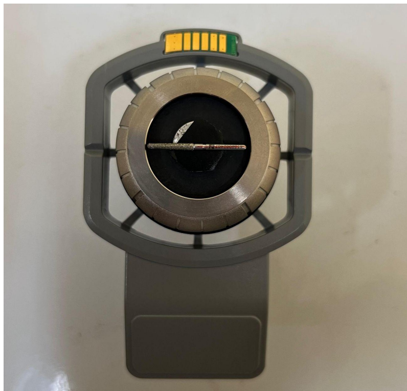
Figura 11. Ponta diamantada acoplada no porta-amostras padrão de 25 mm de diâmetro por 35 mm de altura.
