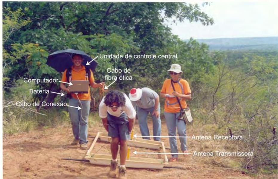
**Fotografia 1.1:** Trabalho de campo para a obtenção de um perfil de reflexão GPR no afloramento CAB-2, com antenas de frequências centrais em 100Mhz.
