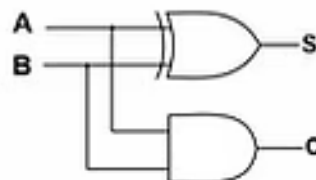
FIGURA 14 - PORTA LÓGICA MEIO SOMADOR (HEAL-ADDER)
