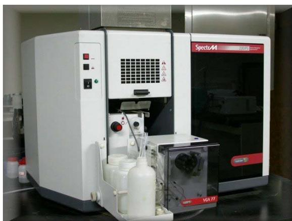
**Figura 17:** Espectrômetro de absorção atômica em chama.
