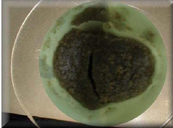
**Figura 19:** Resíduo após tratamento com ácido sulfúrico.
