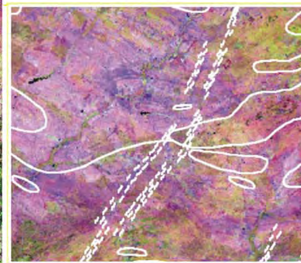
Figura 20 – Composição colorida RGB das segunda principal componente proveniente dos conjuntos B5-B1 (R), B5-B7 (G) e B3-B1(B). Os traços geológicos sobrepostos são os presentes no mapa do ANEXO 5
