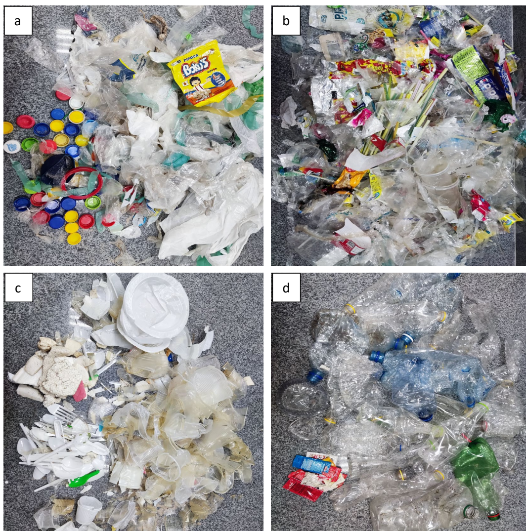
Figura 6 – Resíduos plásticos coletados, após remoção do excesso de areia, organizados nas categorias: (a) polietileno; (b) polipropileno; (c) poliestireno; (d) politereftalato de etileno.
