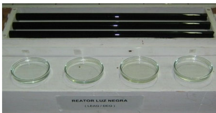
Figura 23: Ensaios após 40 min de reação com luz negra.
