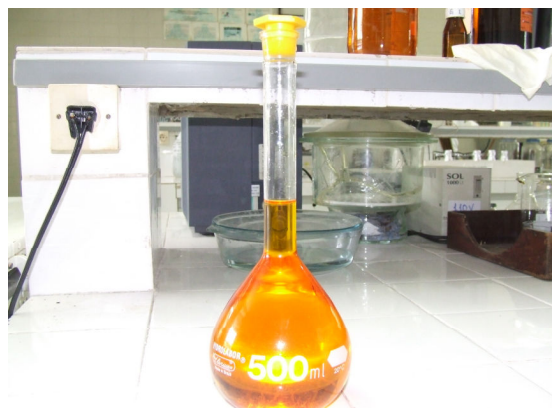
Figura 9: Solução de 100mg/L do Corante Remazol Amarelo Ouro RNL 150%
