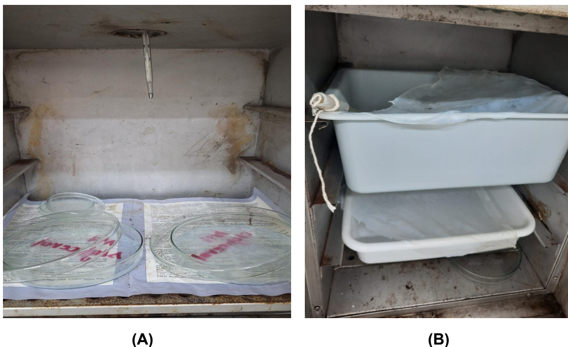
Figura 6 - Biofilmes produzidos em escala laboratorial (A) e obtidos em escala industrial (B) durante secagem em estufa a 50°C.
