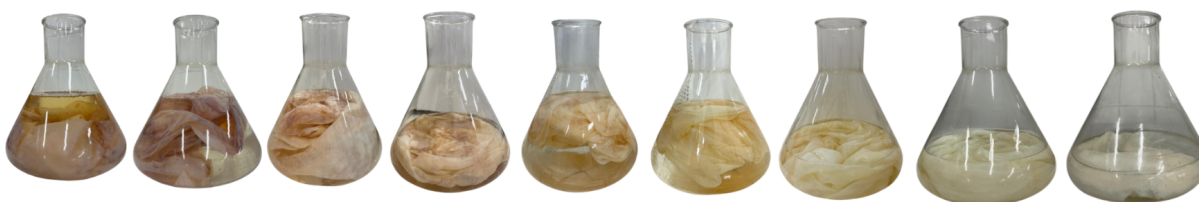
Figura 8 - Processo de purificação do biofilme industrial de celulose de kombucha durante nove dias.
