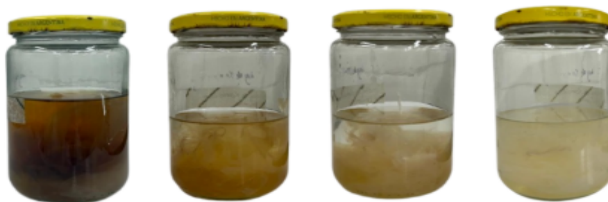
Figura 7 - Processo de purificação dos biofilmes laboratoriais de celulose de kombucha durante quatro dias.
