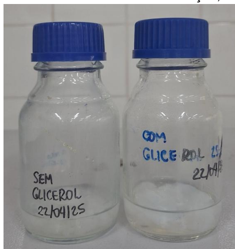
Figura 5 - Filmes em escala laboratorial imersos em solução, com e sem glicerol.
