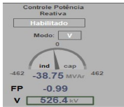
Figura 9 - Tela do controle de potência reativa no sistema de supervisão
