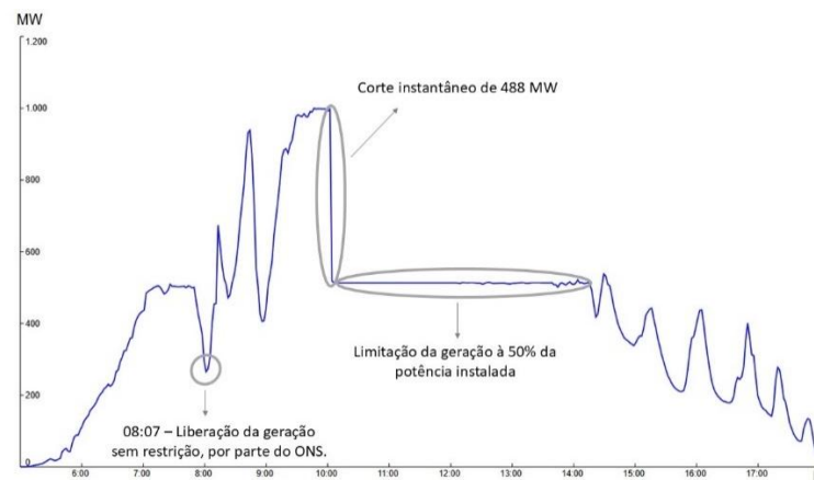
Figura 40 - Corte instantâneo de geração e limitação a 50% no Conjunto Fotovoltaico C, no 2º dia analisado.
