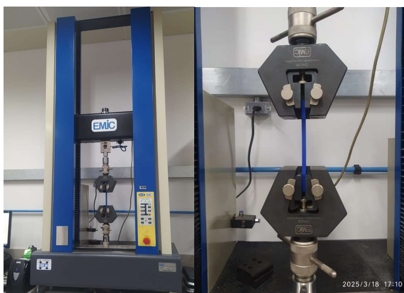
Figure 19 - Configuração dos testes de tração
