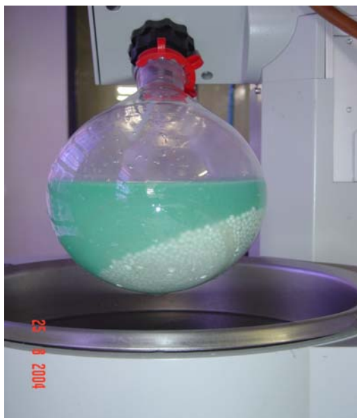
Figura 18 - Pellets de alumina, na solução de nitrato de níquel
