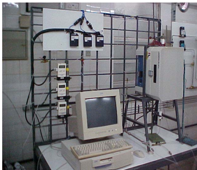
Figura 16 – Sistema formado por micro-reator de quartzo, do tipo leito fixo, forno elétrico Lindberg Blue-M equipado com programador linear de temperatura, e módulo de controladores de fluxo mássico de gás (Coleparmer).
