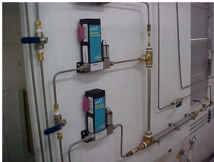
Figura 43 – Acessórios do reator de leito fluidizado, composto do módulo de fluxo mássico, misturador e desumidificador de gases
