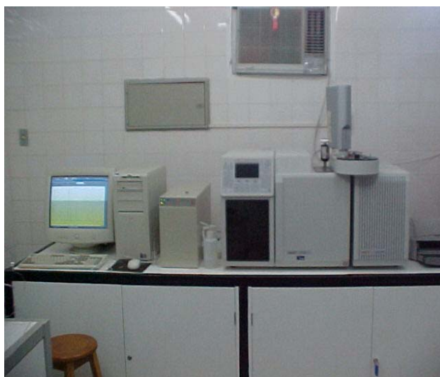
Figura 22 – Conjunto representativo do sistema de análise dos resultados composto de cromatógrafo de condutividade térmica, saída de dados e impressora
