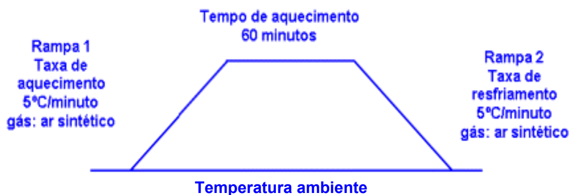
Figura 15 - Esquema simplificado das rampas de temperatura aplicadas ao pré-tratamento térmico da alumina.
