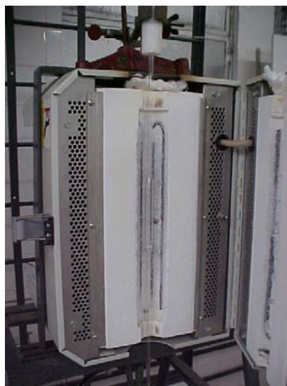
Figura 17 – Vista do micro-reator do tipo leito fixo no forno elétrico aberto marca Lindberg Blue-M.
