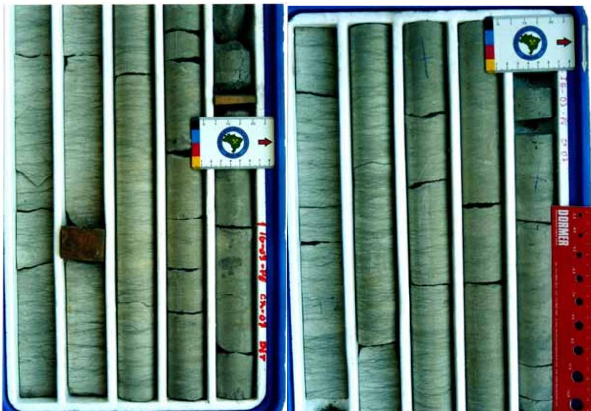
Foto VI.4 - Detalhe do testemunho 1 IG-03-PE (Formação Gramame). Notar a seqüência de calcários bioturbados, vistos em detalhe anteriormente. Esse padrão é observado também em todos os afloramentos visitados. Embora a intensidade varie, e a diversidade de icnogêneros seja baixa, há sempre razoável bioturbação nesses calcários.
