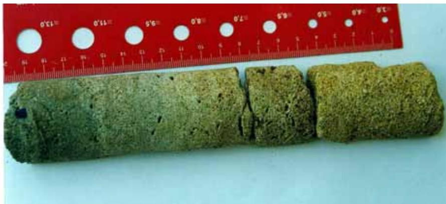
Foto III.3 - Testemunho do furo 1 PL-01-PE de Paulista, Pernambuco, mostrando a passagem de um arenito mais grosso (direita) para um arenito mais fino (esquerda); esse nível, mais fino, possui cimento carbonático e fragmentos de conchas. (Formação Itamaracá).
