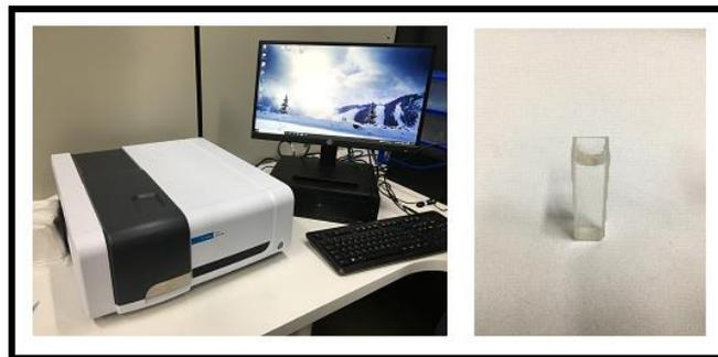
**Figura 7** Espectrofotômetro AGILENT, Cary 60 UV-Vis e cubeta de quartzo de 1,0cm.
