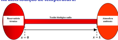
Figura 1. Tecido biológico unidimensional com espessura L , trocando calor entre dois ambientes a diferentes temperaturas.
