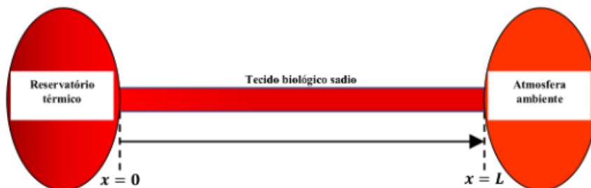
Figura 1 – Tecido biológico com espessura L , em uma dimensão, trocando calor com dois ambientes em temperaturas diferentes.
