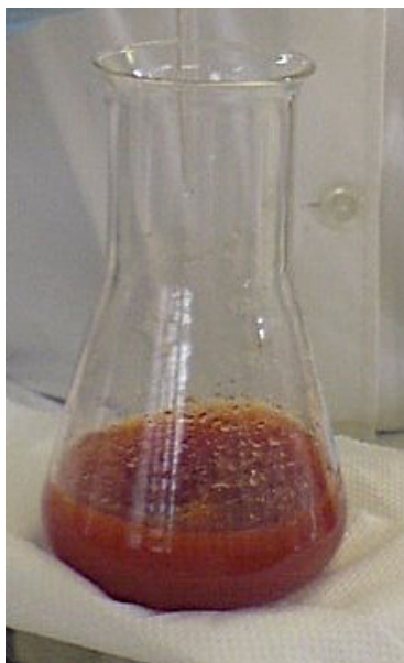
Figura 4.2 - Ponto final da titulação pelo método de Volhard
