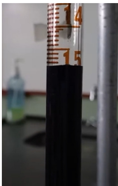
Figura 1.3 - Bureta preenchida com solução de \text{KMnO}_4 .
