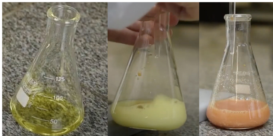
Figura 4.1- Solução inicial após a adição do indicador; após adição de íons de prata, antes do ponto final da titulação; e no ponto final da titulação
