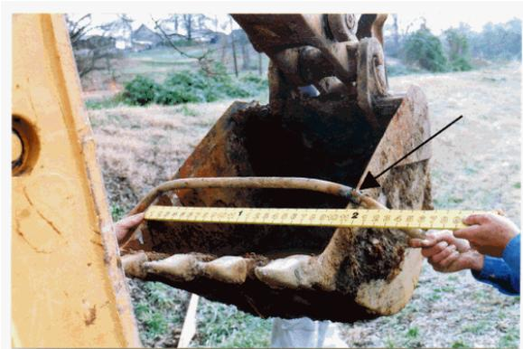
*Figura 2.2 - Seção danificada da linha de serviço do gás.*
