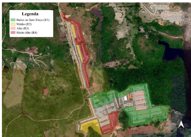
Figura 44 – Mapeamento das áreas com risco de deslizamento (01) – Barreiros.
