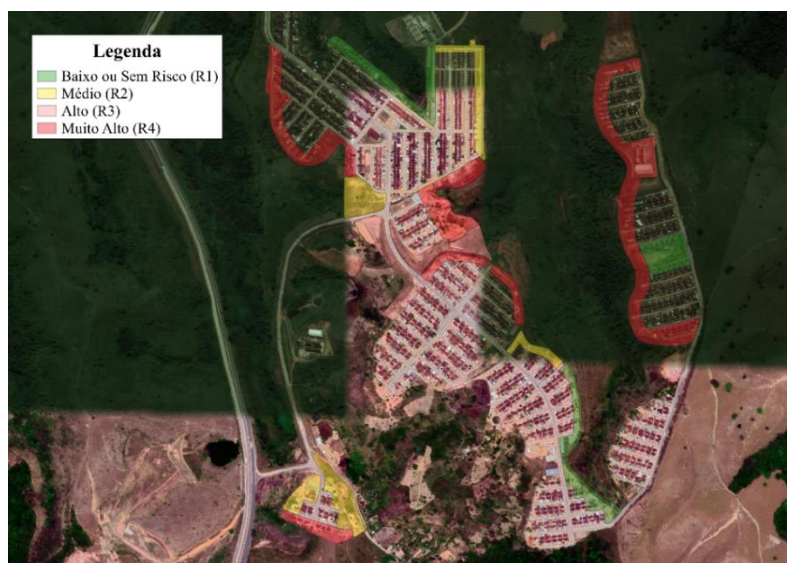
Figura 43 – Mapeamento das áreas com risco de deslizamento – Palmares.
