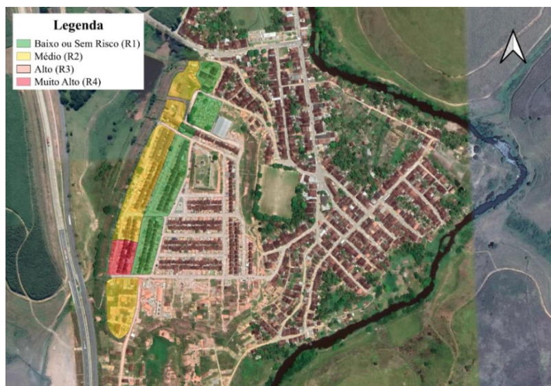
Figura 48 – Mapeamento das áreas com risco de deslizamento – Xexéu.
