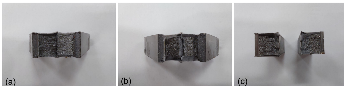
Figura 43 – Corpos de prova GMAW - Metal Base (a), Junta soldada superior (b) e Junta soldada inferior (c) após ensaios de impacto a 0 °C.
