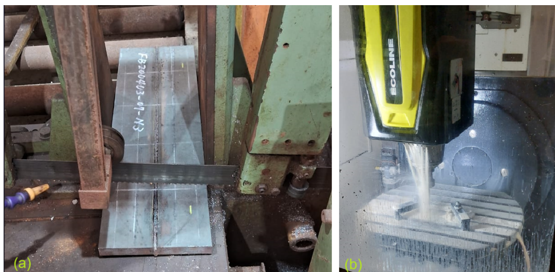
Figura 26 – Preparação dos corpos de prova para ensaios de tração através de serra fita (a) e fresadora CNC (b).
