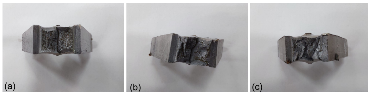
Figura 42 – Corpos de prova HLAW - Metal Base (a), Junta soldada superior (b) e Junta soldada inferior (c) após ensaios de impacto a 0 °C.
