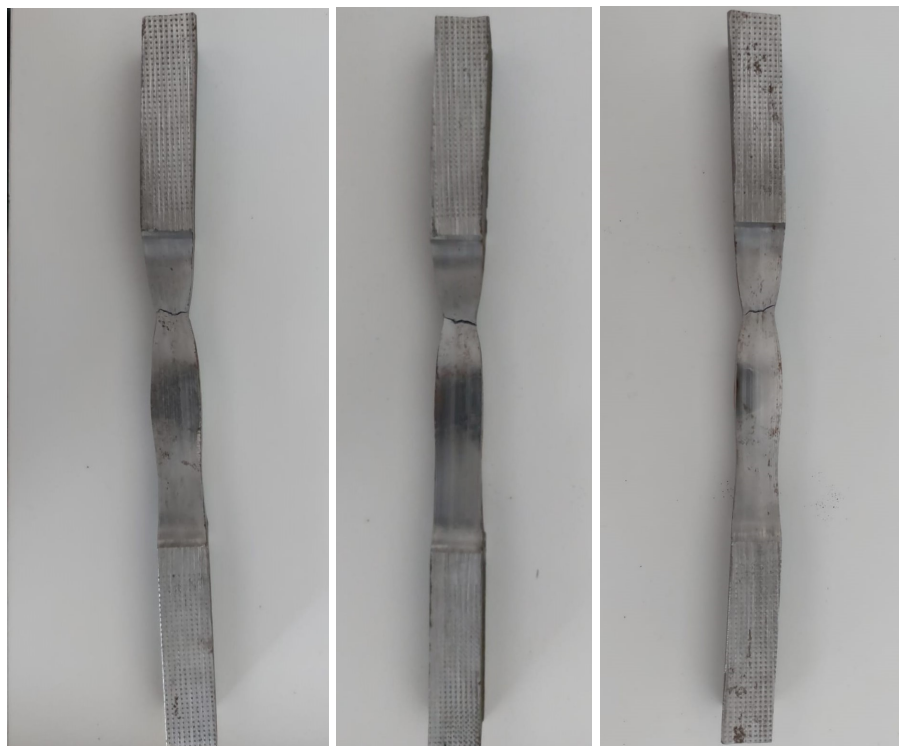
Figura 37 – Corpos de prova GMAW após ensaios de tração.
