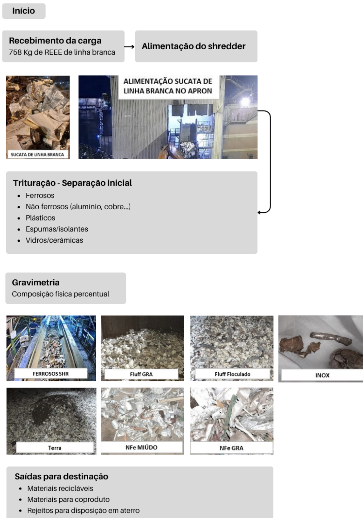
Figura 28 – Processamento de REEE de linha branca recolhidos pela empresa ‘A’ no shredder da empresa ‘B’.
