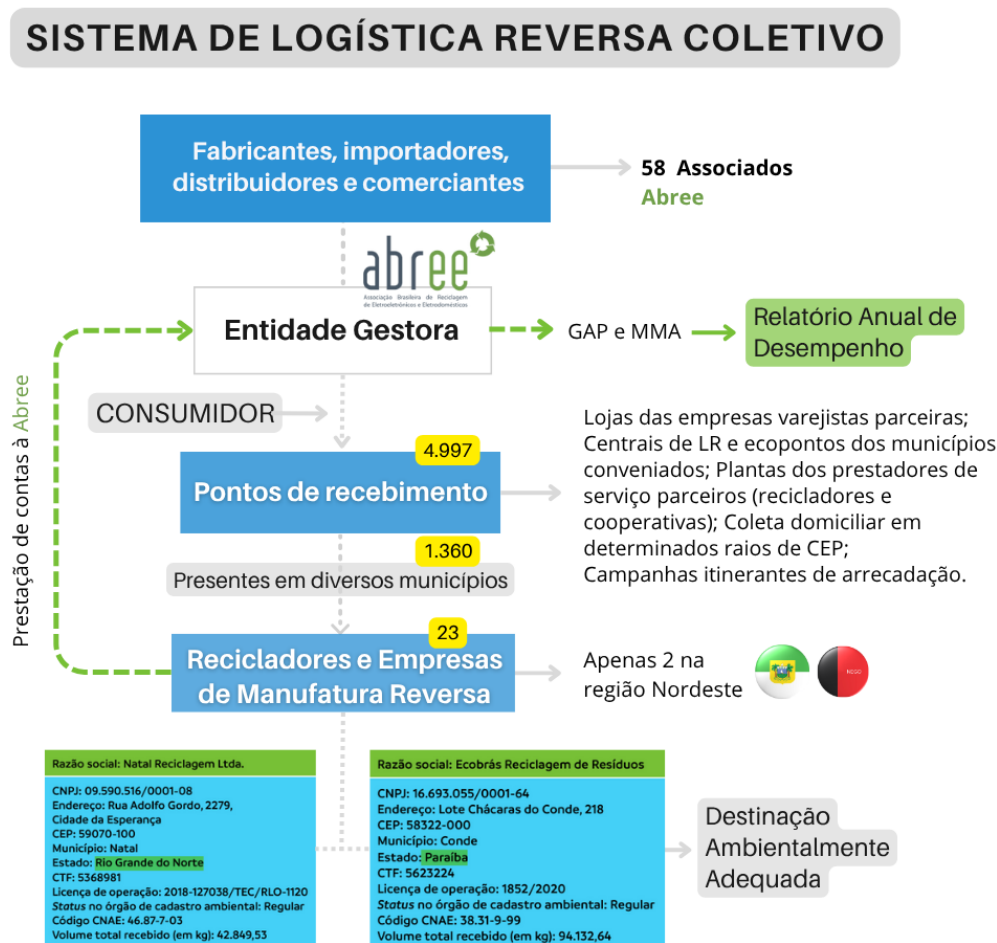
Figura 25 – Macrofluxo operacional detalhado aplicado aos REEE.
