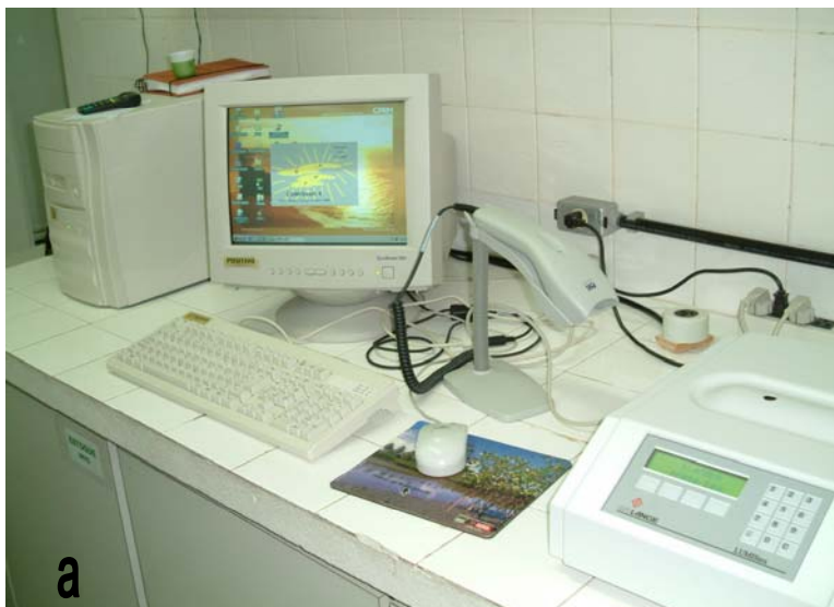
Figura 26a - Equipamento LUMISTox constituído por um luminômetro com unidade integrada de comando e medição. Fonte: Foto Dr. Kinie – Laboratório de Ecotoxicologia da CPRH (2003).
