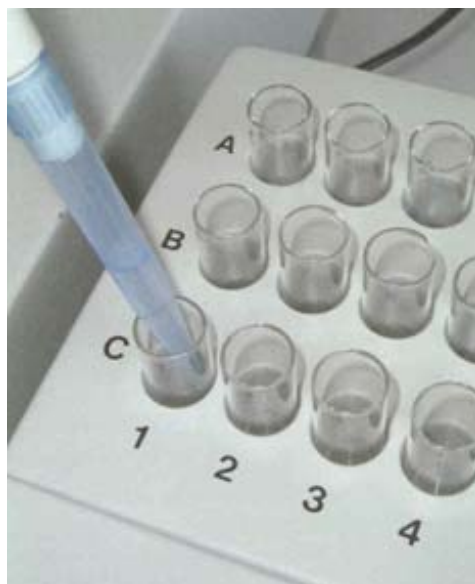
Figura 35 – Transferência da solução-controle para cubeta C1. Fonte: Testes Ecotoxicológicos, Métodos, Técnicas e Aplicações.
