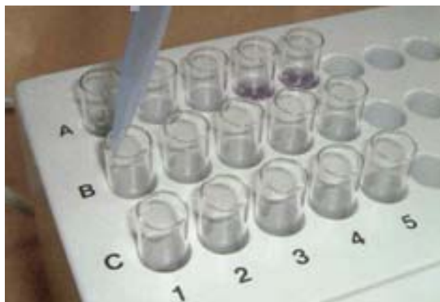
Figura 34 – Transferência da solução-controle para a cubeta B1. Fonte: Testes Ecotoxicológicos, Métodos, Técnicas e Aplicações.
