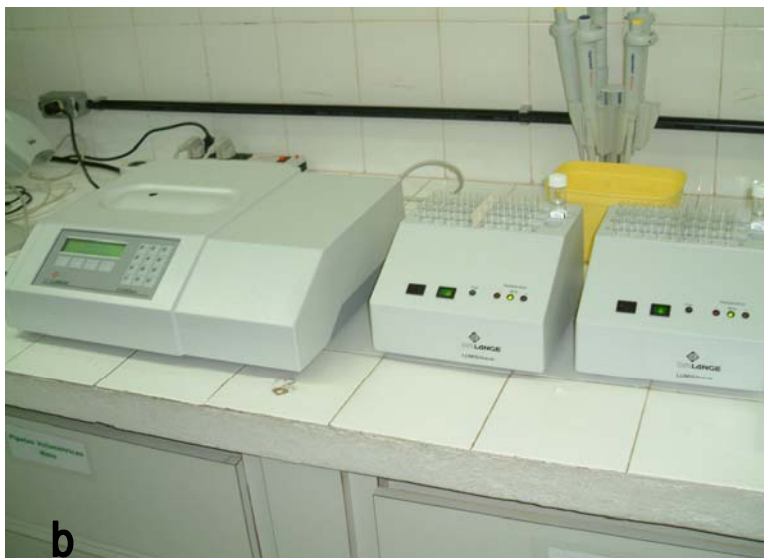
Figura 26b - Equipamento LUMISTox com termoblocos (incubadoras). Fonte: Foto Dr. Kinie – Laboratório de Ecotoxicologia da CPRH (2003).
