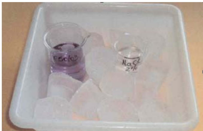
Figura 27 - Recipiente contendo amostra e solução de diluição (NaCl) em banho de gelo. Fonte: Testes Ecotoxicológicos, Métodos, Técnicas e Aplicações.
