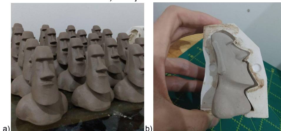
FIGURA 24 - Múltiplos a) Formas padronizadas; b) Retração de massa.
