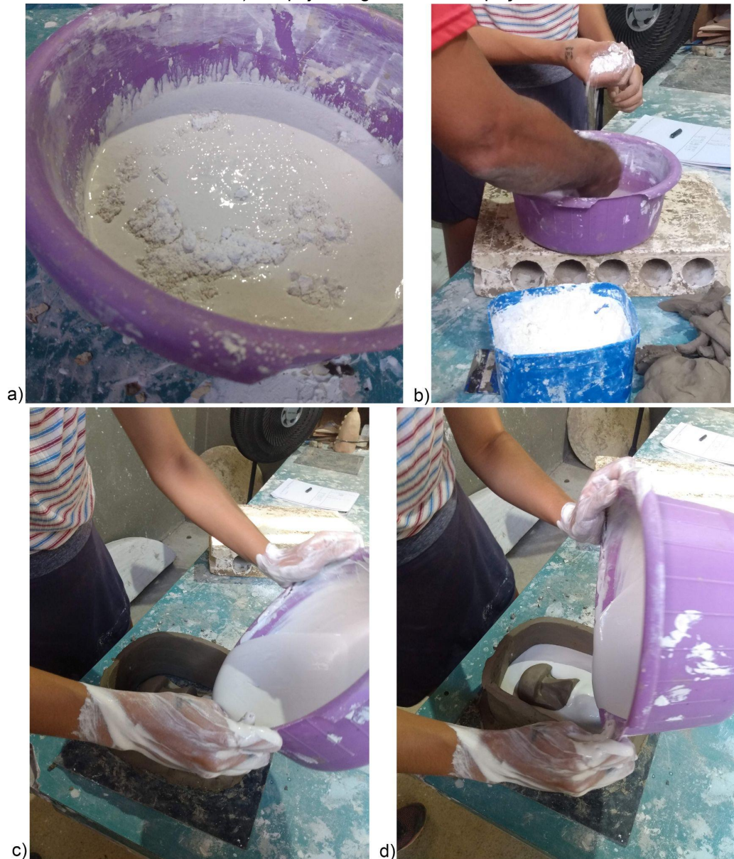
FIGURA 2 - Preparação do gesso a) Gesso, formação de ilhas; b) Preparação de gesso; c) Despejando gesso sobre a peça; d) Despejando gesso sobre a peça.
