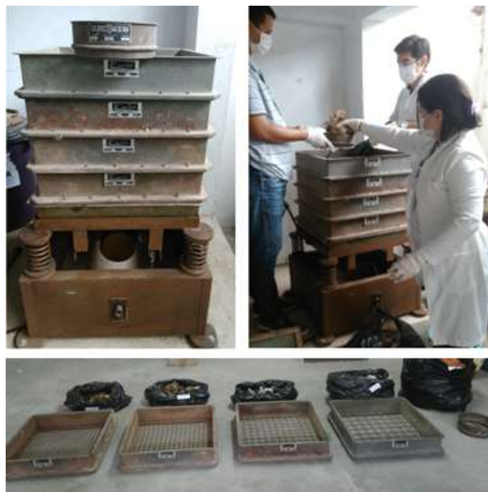
Figura 15. Série de peneira para fração grossa e peneiramento sob agitação mecânica.
