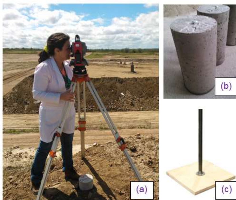
Figura 18. Equipamento utilizado na leitura dos deslocamentos (a); Marco topográfico (b); placa de Recalque (c).
