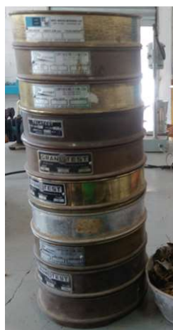
Figura 16. Série de peneiras circulares utilizadas no peneiramento da fração fina.
