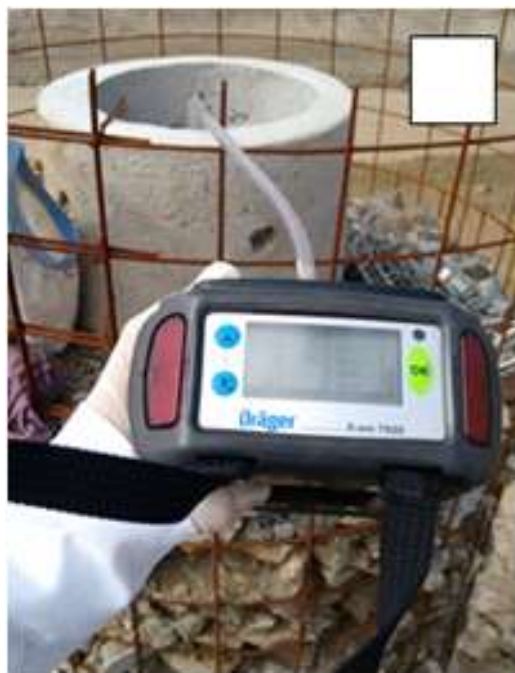
Figura 21. Monitoramento da concentração dos gases nos drenos com o uso do Dräger
