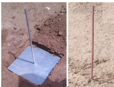
Figura 11. Placa superficial para monitoramento de recalques superficiais
