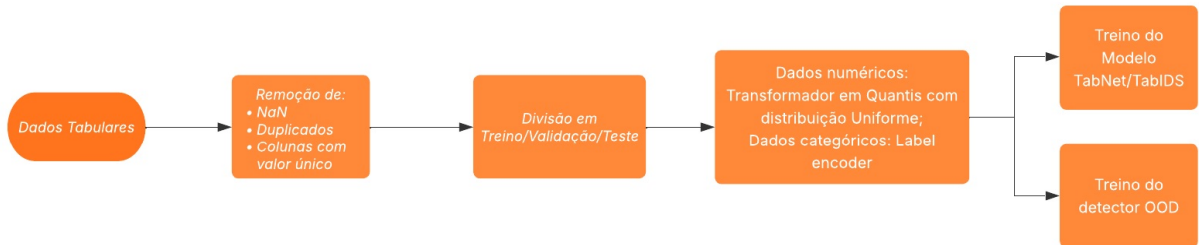
Figura 9 – Fluxo do Pré-processamento e treino do modelo
