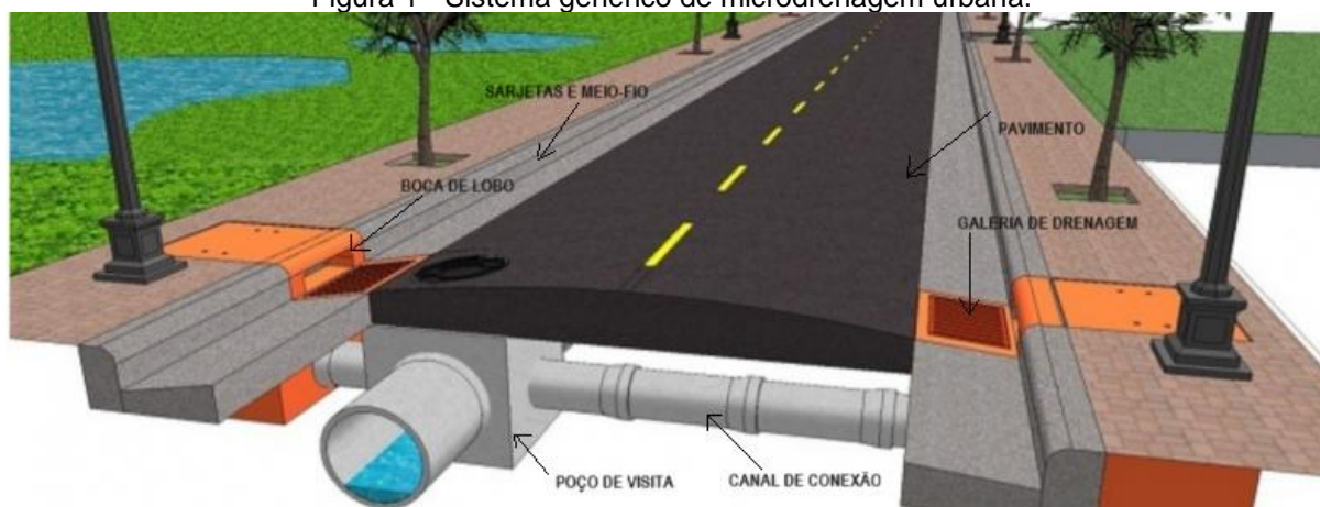
Figura 1 - Sistema genérico de microdrenagem urbana.
