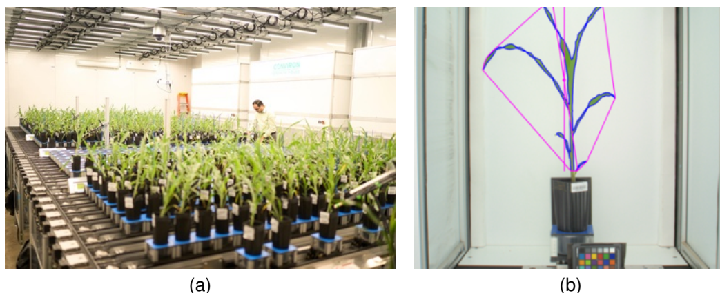
Figura 2 – Imagens do sistema de fenotipagem vegetal da Donald Danforth Plant Science Center , MO, EUA: (a) estufa de crescimento em laboratório de fenotipagem com, esteiras, sensores, irrigação e pesagem automatizada, (b) extração de características fenotípicas por imagem em câmara controlada. Fonte: Danforth (2025).
