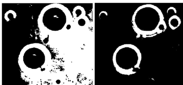
Figura 93 – Segmentação de imagens baseada em dois algoritmos diferentes. (Esq.) Segmentação usando algoritmo global básico e (dir.) segmentação usando método de Otsu. Fonte: Gonzalez e Woods (2008).
