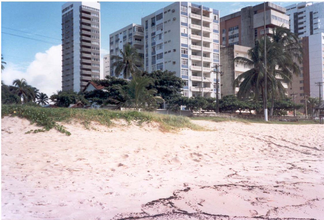
Figura 22: Aspecto geral da faixa de praia do setor 3 ao final da década de 80. Nota-se o grande estoque de sedimentos na porção da pós-praia, que era marcada, também, pela presença de vegetação rasteira, grande responsável pela retenção do material arenoso destas praias. Foto: Maia Melo Engenharia, 1989.
