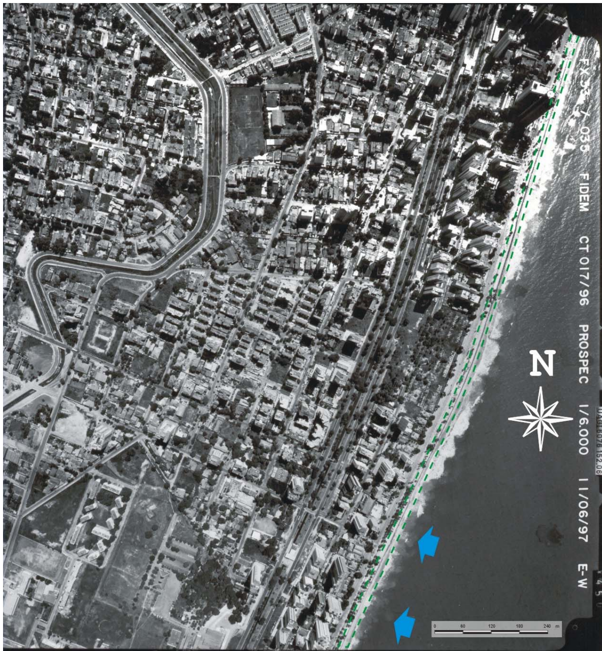
Figura 29: Fotografia aérea de parte do setor 3 no ano de 1997. A linha pontilhada verde delimita o extenso enrocamento construído próximo ao calçadão da Av. Boa Viagem, como estrutura de defesa costeira ao ataque das ondas, que no início da década passada alteraram profundamente as características da praia local. As setas em azul apontam para plumas de sedimentos originadas pelas correntes de retorno.
