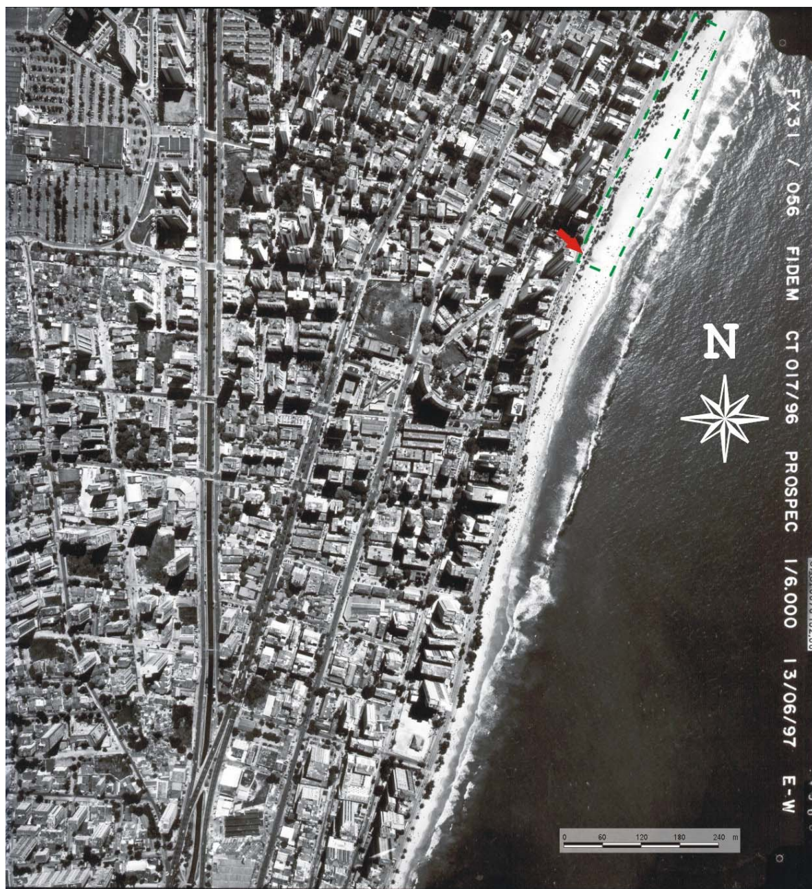
Figura 28: Fotografia aérea do setor 2 no ano de 1997. A área da célula 1 (linha pontilhada verde) apresentou um aumento na largura da faixa de praia, com pequena redução da área vegetada. A seta em vermelho indica o ponto de descarga da galeria de águas pluviais da Rua Bruno Veloso.
