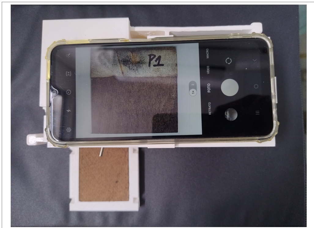
Figura 23 – Suporte de captura de imagens de palheta de ovitrampa com smartphone posicionado
