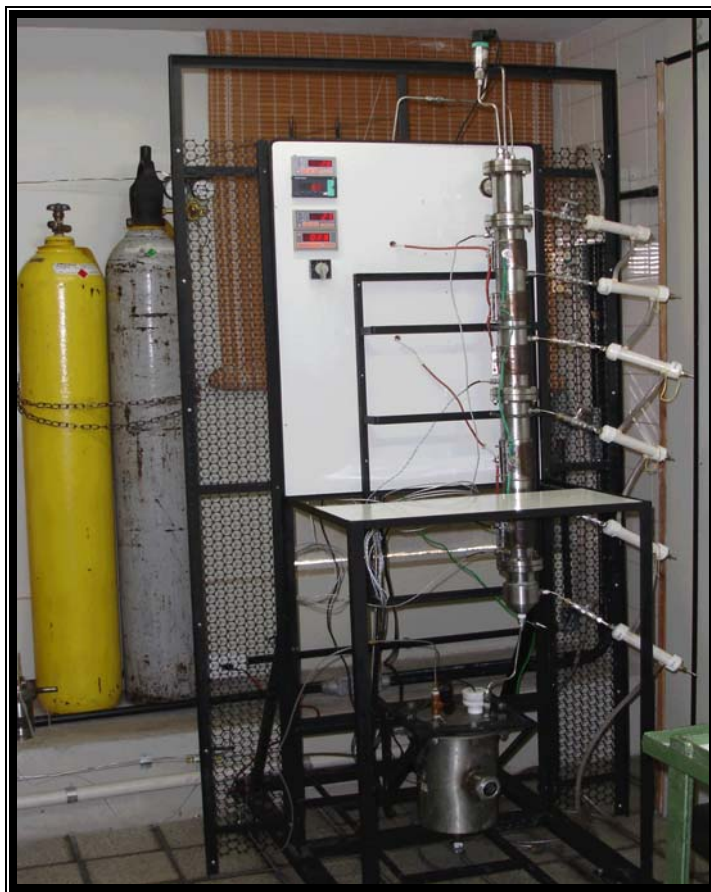
FIGURA 2.3 – Unidade de hidrogenação de sacarídeos. Reator de leito gotejante.
