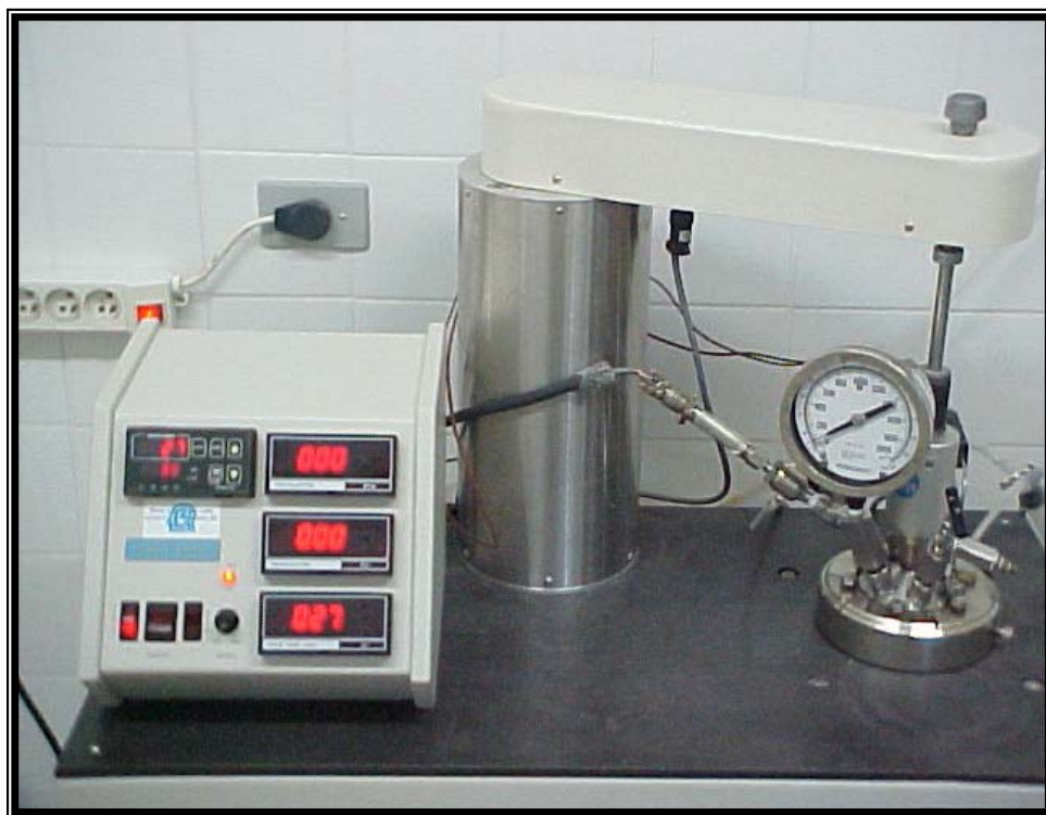
FIGURA 2.2 – Reator descontínuo de leito de lama (PARR 4531) (direita) e controlador de temperatura, pressão e agitação tipo PID (PARR 4843) (esquerda).
