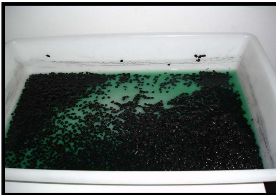
FIGURA 2.1 – Carvão ativado após 48 h de impregnação com a solução de nitrato de níquel hexahidratado.
