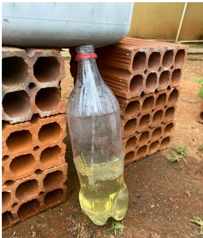
Figura 12 - Vaso atingindo a capacidade de campo, momento em que o solo atinge sua capacidade máxima de retenção de água, resultando no escoamento através do furo no vaso.
