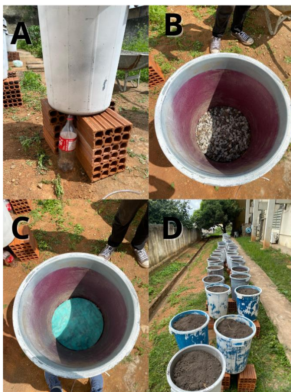
Figura 8 - Processo de Preparação dos Vasos: (A) Furo realizado no fundo do vaso com mangueira conectada a uma garrafa PET. (B) Camada de pedra esmagada (brita) colocada no fundo do vaso. (C) Cobertura da brita com tecido não-tecido (TNT). (D) Preenchimento dos
