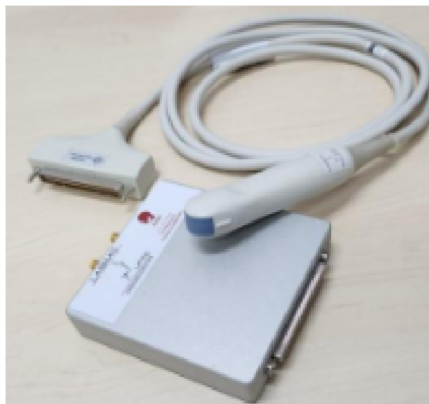
Imagem 4: Ultrassom portátil MicrUs EXT – 1H com transdutor micro convexo
