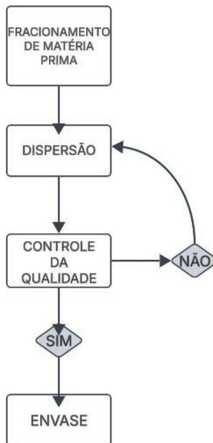
Figura 2. Fluxograma do processo de produção de massa.
