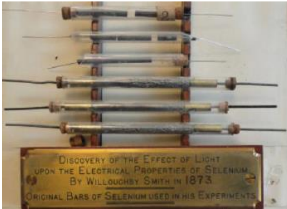
Figura 4 - Barras de Selênio utilizadas no experimento de Willoughby Smith
